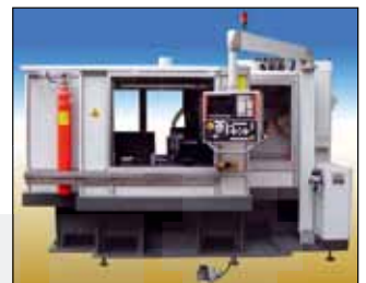
Multischleifzentrum 6-fach Scheibenwechsler mit Körperschallsensor. Schleifen eines Werkstücks in einer Aufspannung mit optimaler Rundlaufgenauigkeit im µm Bereich.
