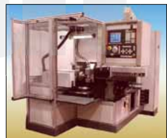
Vollautomatische 5-Achsen Anfasmaschine Endenbearbeitung von HM-Rundstäben
