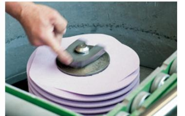
*Scharfmacher: Je sorgfältiger die Scheibe abgerichtet ist, desto präziser ist der Spanabtrag.*
